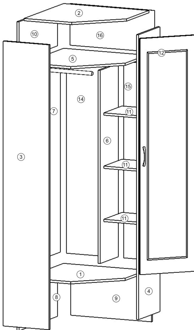
4. Установите прихожую на место, где она будет находится, выровняйте при помощи опор 195 и закрепите к стене дюбель-гвоздями 117. Закрепите петли на двери шурупом 54 на места кернения, ответную планку петли закрепите на бок 4 шурупами 54, установите двери вставив до щелчка петлю в ответную планку.
